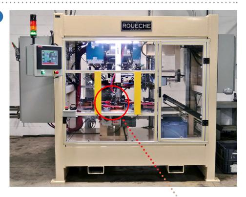
Four-Station Indexing Stud Welder
